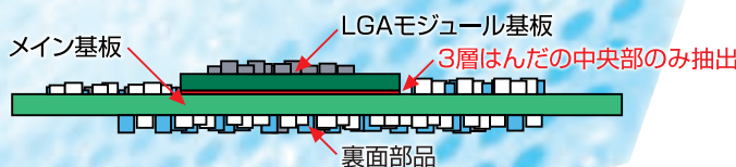
2D透過画像 モジュール基板+メイン基板の重なり画像
