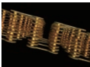
CT撮影した基板内層の3Dグラフィック出力
